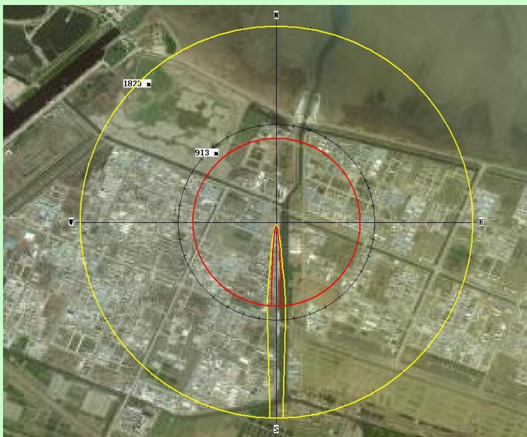
图 6.7-3 三氯氧磷储罐泄漏次生污染事故（氯化氢）超风险物质毒性终点浓度范围图
